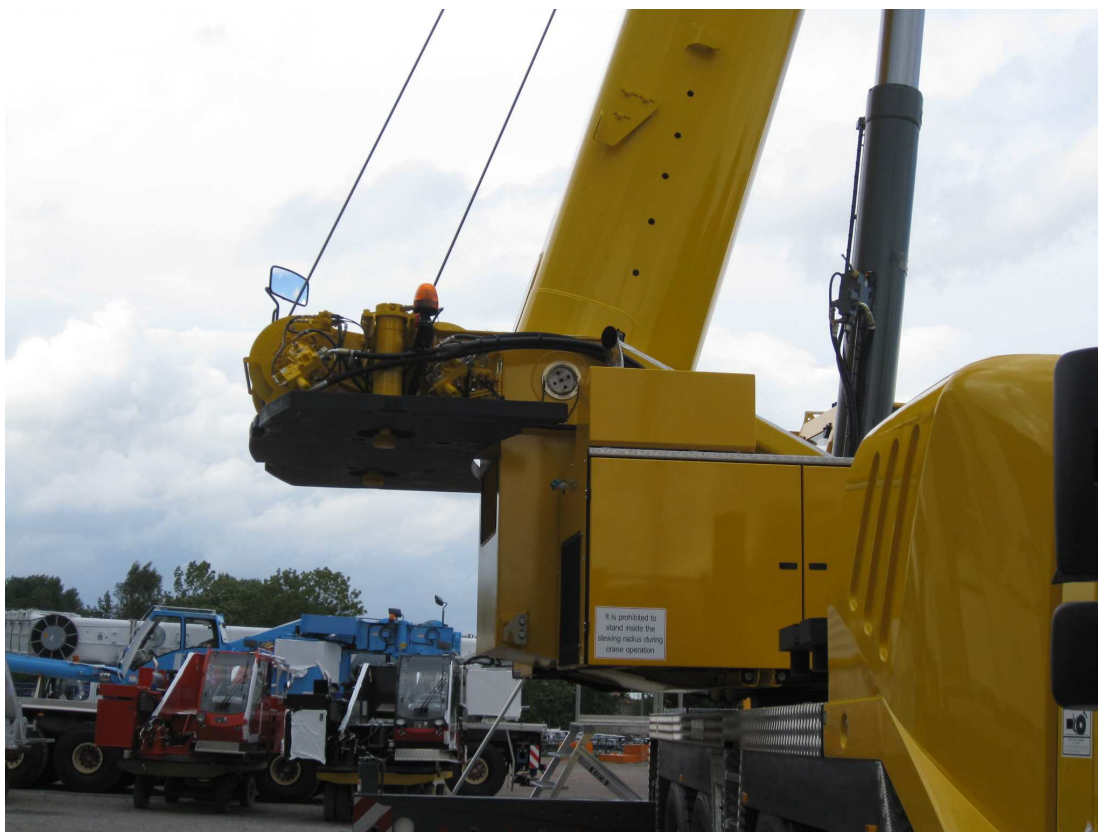
Dva navijáky (přídavný naviják je rozšiřující výbava)
