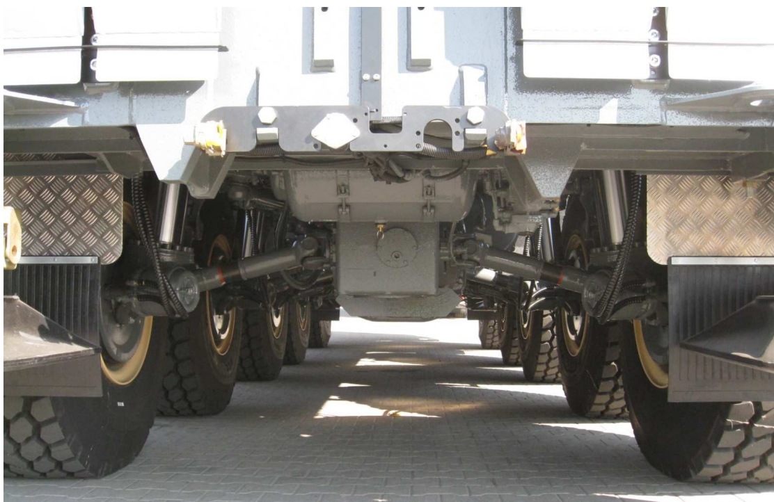
Podvozek MEGATRAK™. Dobře je vidět diferenciál uchycený na spodní části skříňě podvozku a kardany pohonu kol
