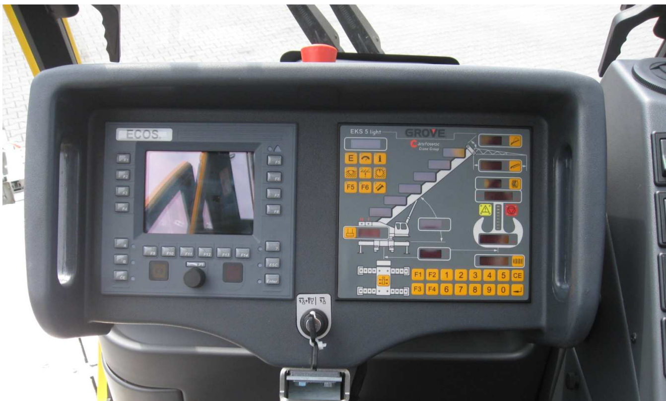
Přístrojový panel v kabině jeřábíka s displeji systémů ECOS a EKS 5 Light
