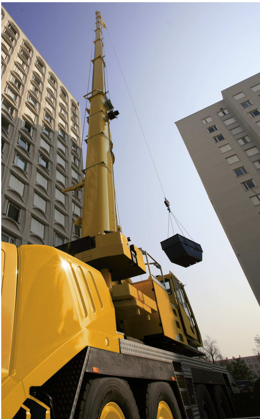
Výložník 60m s nastrojeným hydraulickým nástavcem
